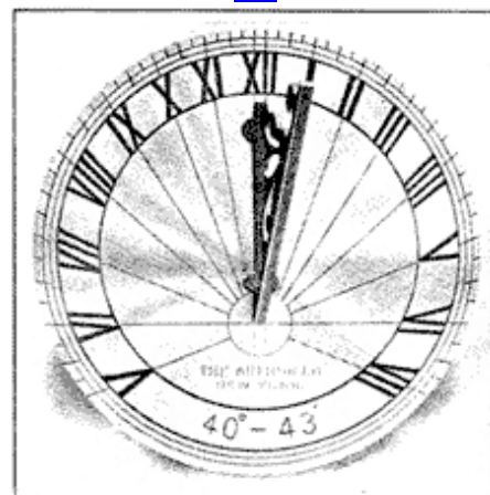
Fig. 4—12-Inch Modern Horizontal Sundial for Latitude 40°-43'
